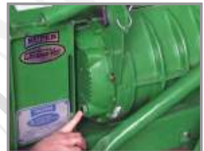
Смотровой глазок для контроля за уровнем масла в подшипниковых узлах
