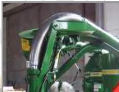
Выгрузная штанга для регулирования высоты выгрузки и возможности вращения на 360 градусов
