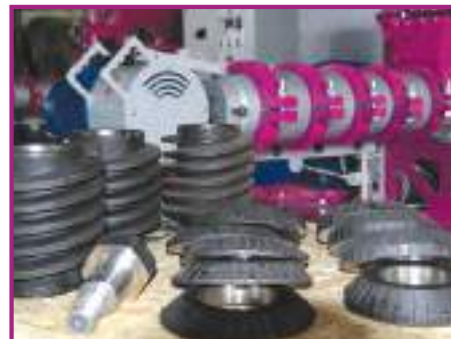
Секции шнека и размольные кольца с износостойким покрытием
