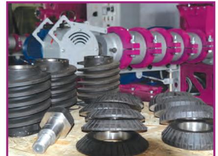
Специальное износостойкое упрочнение шнеков и размольных колец
