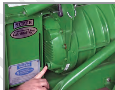
Смотровой глазок для контроля за уровнем масла в подшипниковых узлах
