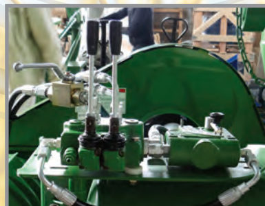
Рукоятки управления пневмошлюзом и гидравлической системой
