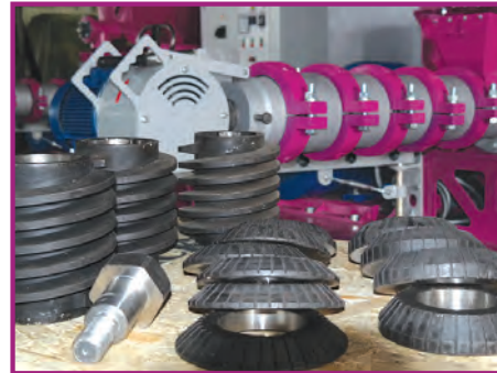
Специальное износостойкое упрочнение шнеков и размольных колец
