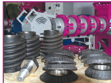
Специальное износостойкое упрочнение шнеков и размольных колес
